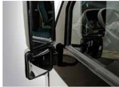
İlave Kaldırım Aynası
